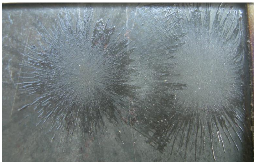
Рис. 5. Результати наплення температура повітря 450 °С. Попередній прогрів підкладки 300 °С.
