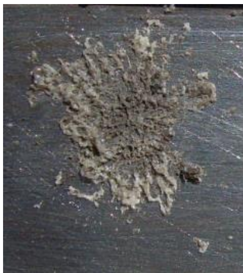
Рис. 3. Результати наплення температура повітря 300 °С. Попередній прогрів підкладки 100 °С.
