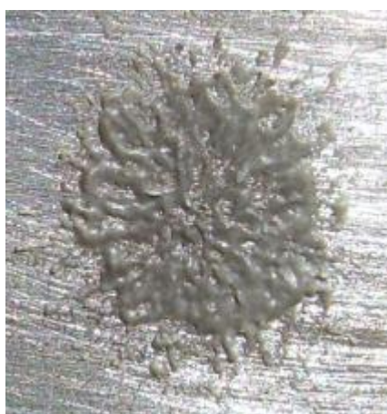
Рис. 4. Результати наплення температура повітря 350 °С. Попередній прогрів підкладки 200 °С.
