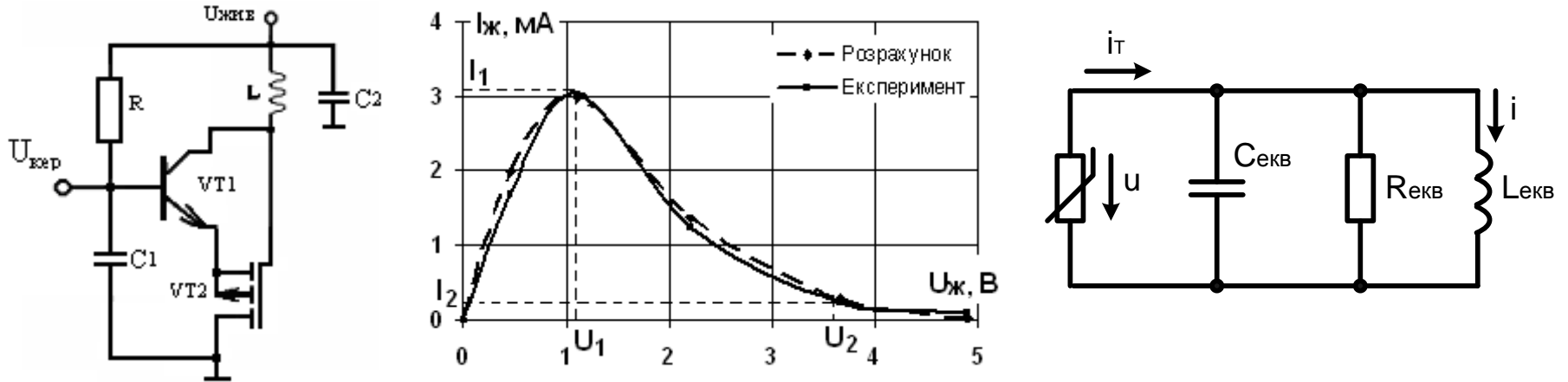
Рисунок 1 – Електрична схема, ВАХ та еквівалентна схема генератора синусоїдальних коливань
