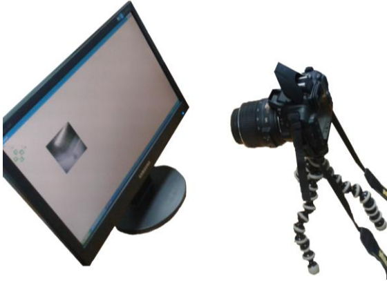
Рисунок 4 – Схема експериментального макета імітаційного засобу контролю краю зображення об'єкта, що формувалося фотокамерою, та уточнене внаслідок використання запропонованого методу, показані на рис. 6. З рисунка видно, що при зсуві зображення краю об'єкта на моніторі в рамках одного пікселя положення зображення краю об'єкта на відеокамері не змінюється. Але при використанні запропонованого методу положення локалізованої координати має субпіксельне зміщення відносно крайового пікселя.
