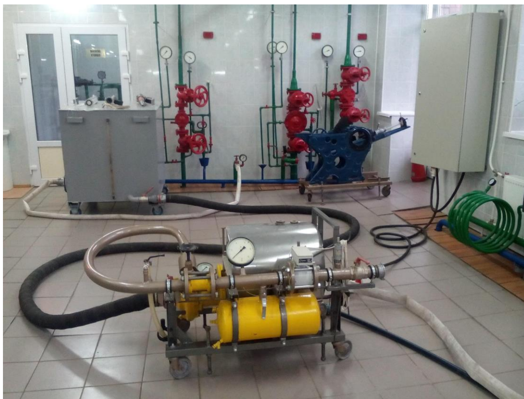
Рисунок 1 – Установка для дослідження водяних струменів
