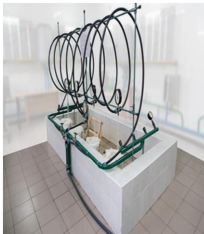
Рисунок 2 – Стенд, що дозволяє моделювати течію рідини із змінною вздовж потоку масою
