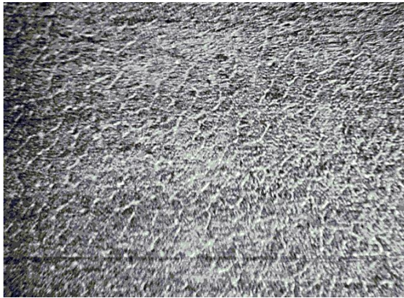
Рис. 2. Мікроструктура зміцнених поверхонь при швидкості переміщення електроду 23 м/год та 17 м/год (x300)
