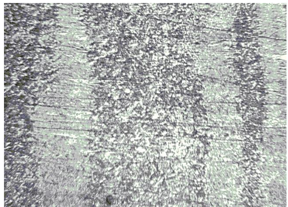
Рис. 3. Мікроструктури зміцнених поверхонь при швидкості переміщення електроду 11 м/год (x300)
