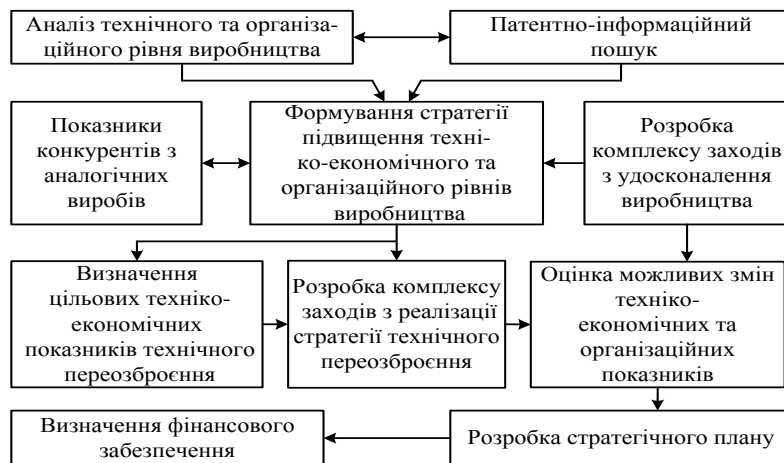
Рисунок 1 – Схема розробки стратегічного плану технічного переозброєння виробництва
