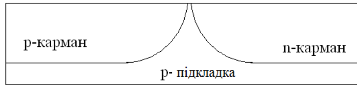
Рисунок Е.1 – Ескіз поперечного перерізу КМДН-структури (операції № 1–9 технологічного маршруту)
