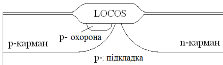
Рисунок Е.3 – Ескіз поперечного перерізу КМДН-структури (операції № 19–21 технологічного маршруту)
