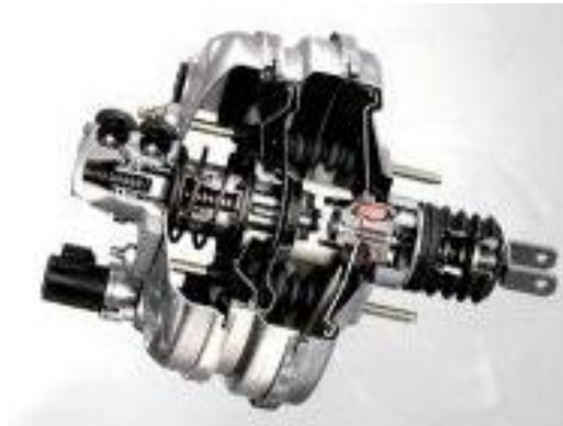
Рис. 1 – Конструктивна система автоматичного екстреного гальмування
