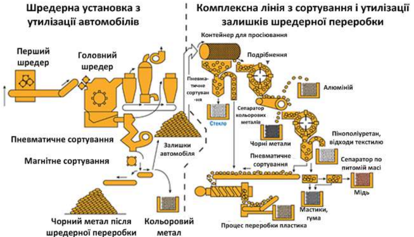
Рисунок 1 – Шредерна установка (схема роботи та зовнішній вигляд)
