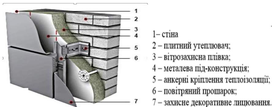
Рис.1- Принципові конструктивні утеплення стіни методом скріпленої теплоізоляції
