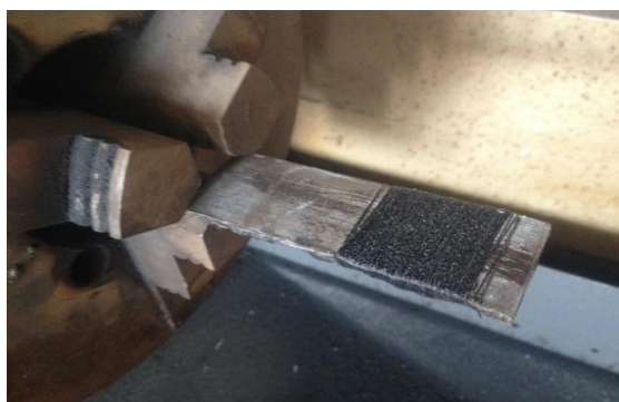
Рисунок 1 – Віскозна нитка, нанесена на поверхню, що наплавляється
