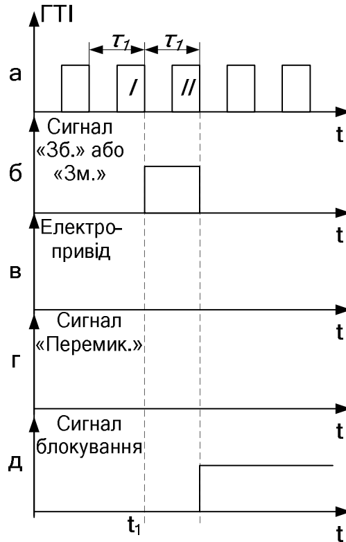
Рис. 2.14. Діаграма сигналів управління регулятора напруги при несправності електроприводу РПН
