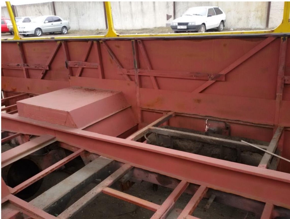
Рис. 3 – Вигляд каркасу кузова автобуса «Богдан А-092» після ремонту
