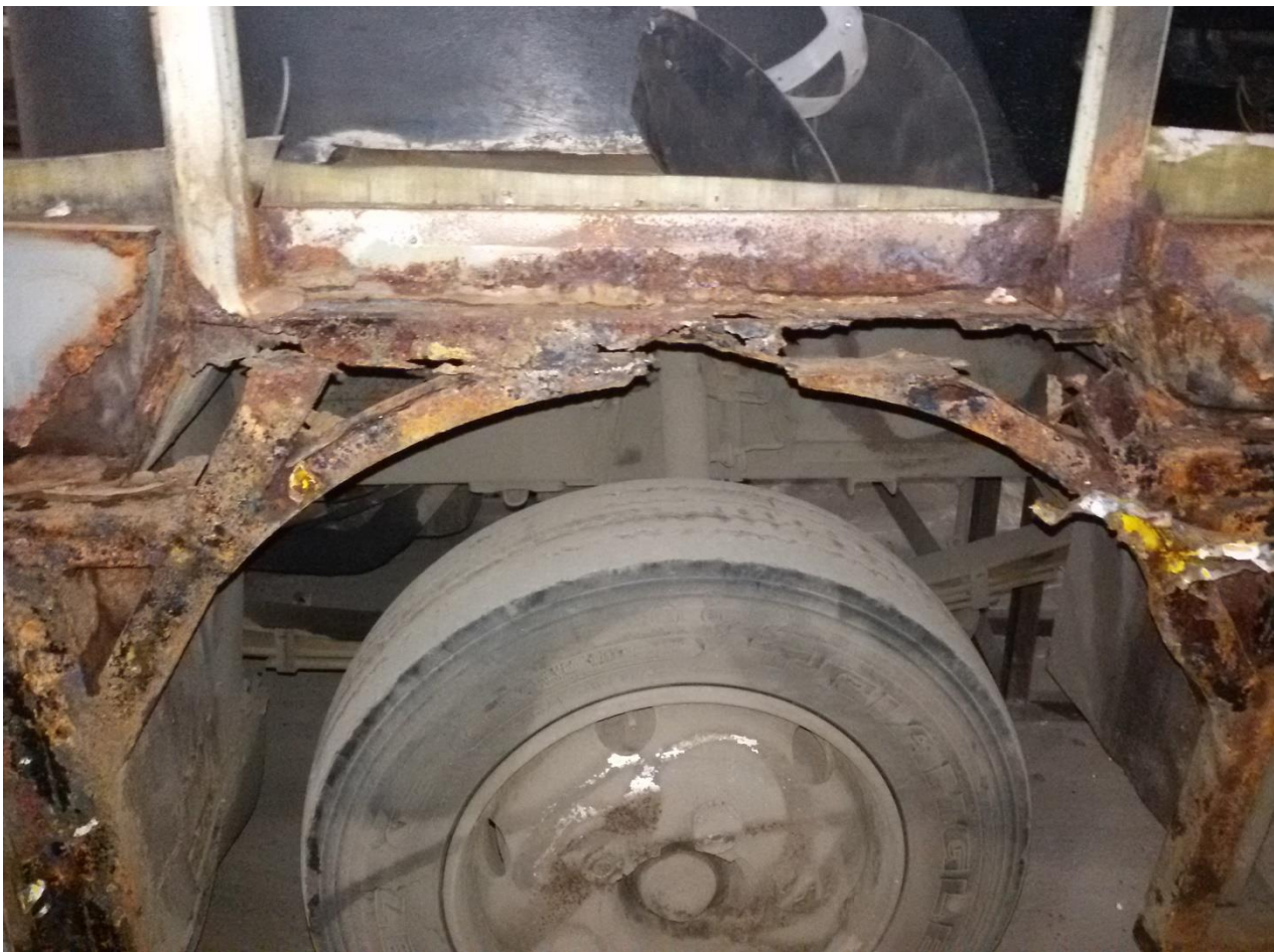
Рис. 1 – Приклад прояву структурної корозії елементів кузова автобуса «Богдан А-092» 2006 р. випуску
