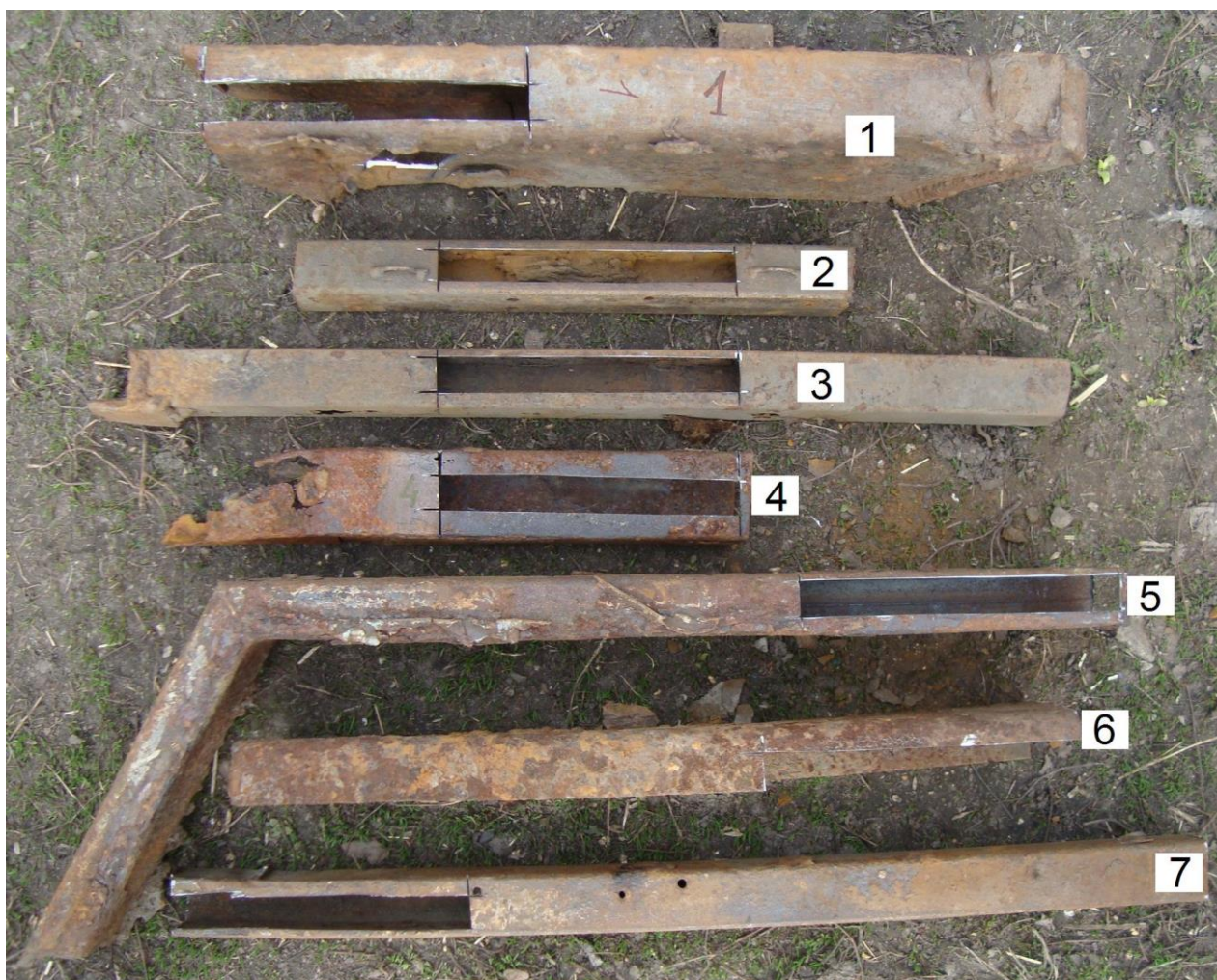
Рис. 4 – Елементи кузова автобуса «Богдан А-092» 2006 р. випуску з яких вирізано дослідні зразки
