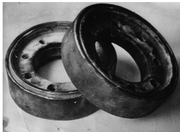
Рисунок 2 – Обод ведущего катка с амортизатором после восстановления
