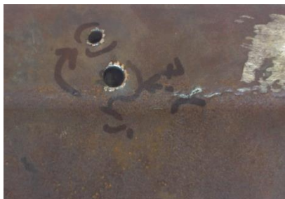
Рисунок 3 – Композиция, полученная сваркой взрывом, после прострела пластины пулями калибра 7.62 и 5.45: а) стали 65Г+алюминий; б) титан+алюминий
