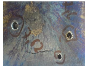
Рисунок 3 – Композиция, полученная сваркой взрывом, после прострела пластины пулями калибра 7.62 и 5.45: а) стали 65Г+алюминий; б) титан+алюминий
