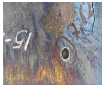
Рисунок 3 – Композиция, полученная сваркой взрывом, после прострела пластины пулями калибра 7.62 и 5.45: а) стали 65Г+алюминий; б) титан+алюминий
