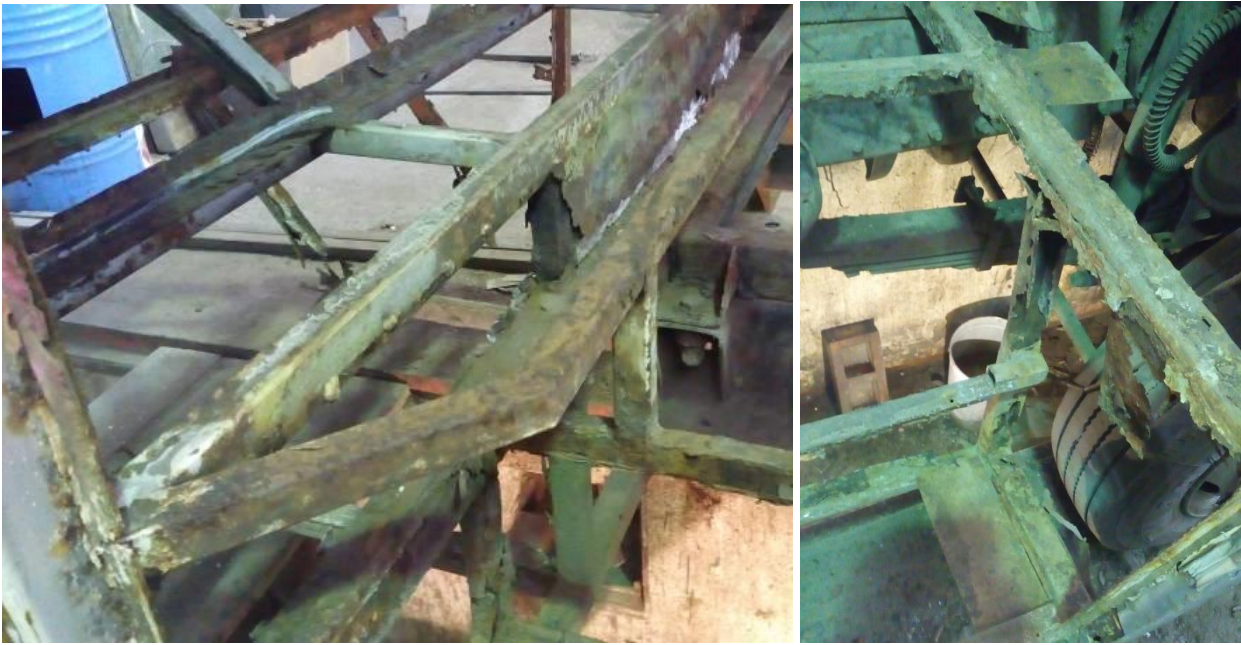
Рисунок 7 – Корозія каркасу автобуса «Еталон А-079» після семи років експлуатації: а) задня частина автобуса б) передня частина автобуса
