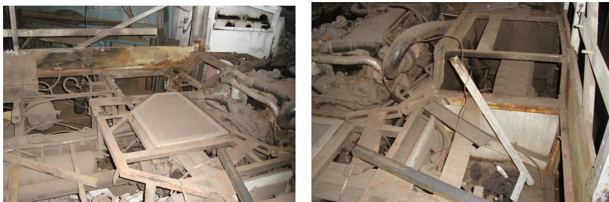
Рисунок 14 – Корозія каркасу моторного відсіку автобуса «Богдан А-092» після п'яти років експлуатації
