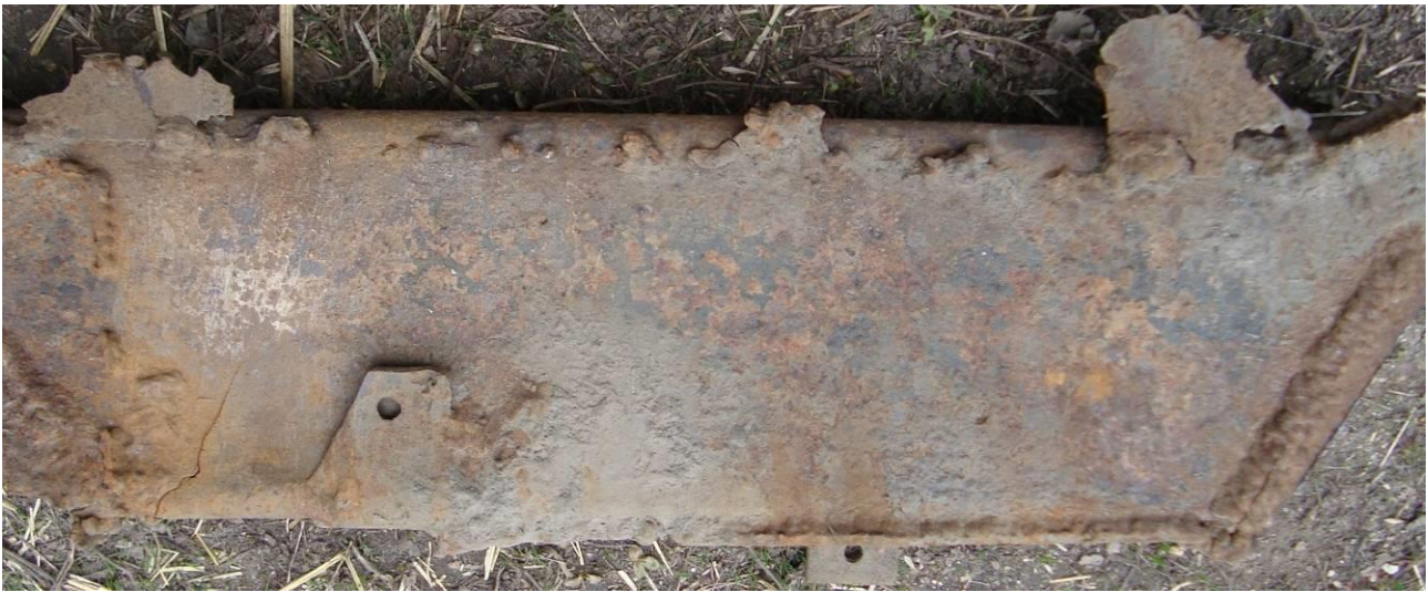
Рисунок 6 – Появи тріщини лонжерона каркасу основи профілем 140x60x3 мм автобуса «Богдан А-092» неподалік площадки пневморесори
