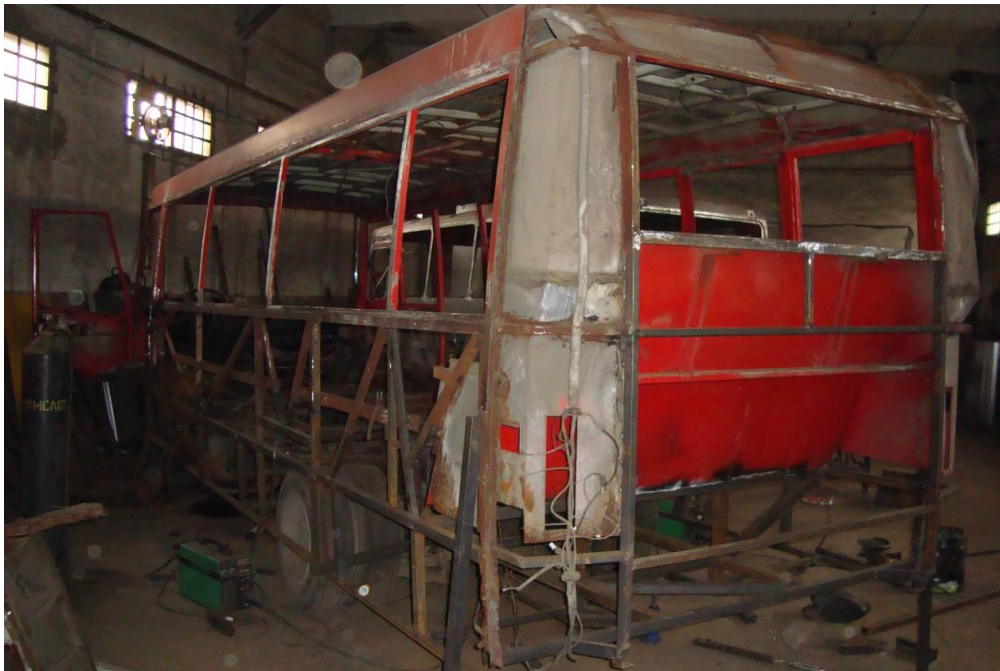
Рисунок 11 – Автобус «Богдан А-092» після дев'яти років експлуатації під час ремонту (заміна ушкоджених елементів каркасу)
