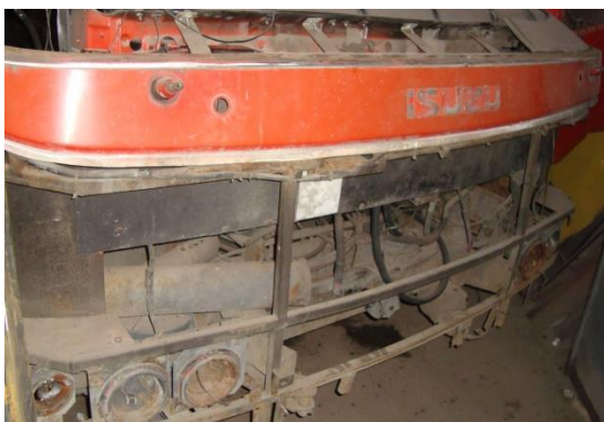
Рисунок 12 – Незначні прояви корозії каркасу передньої частини автобуса «Богдан А-092»: а) після дев'яти років експлуатації; б) після п'яти років експлуатації
