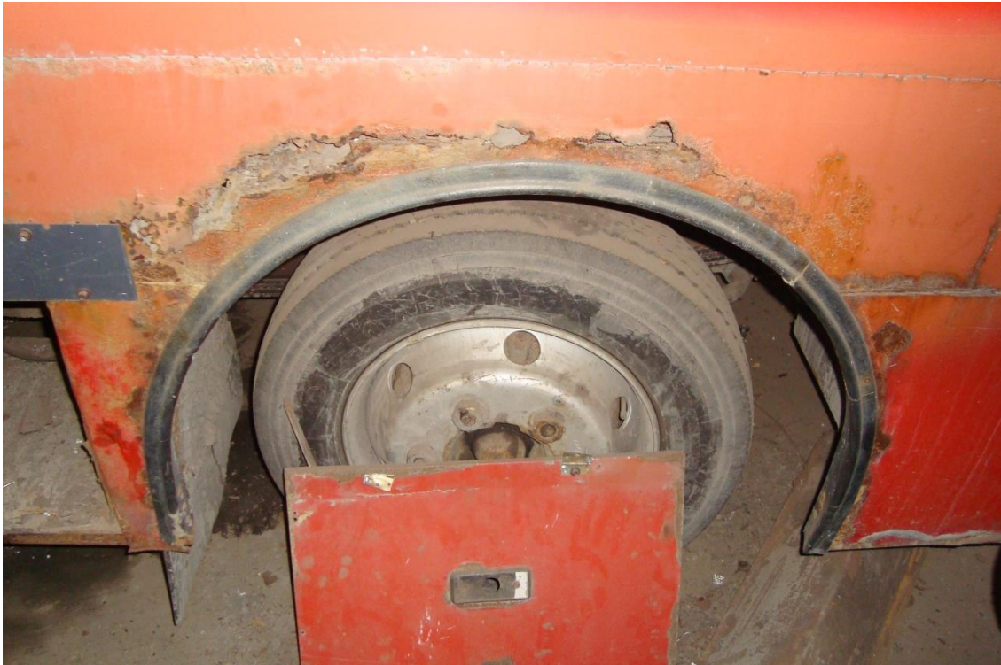
Рисунок 15 – Корозія облицювання автобуса «Богдан А-092» після дев'яти років експлуатації
