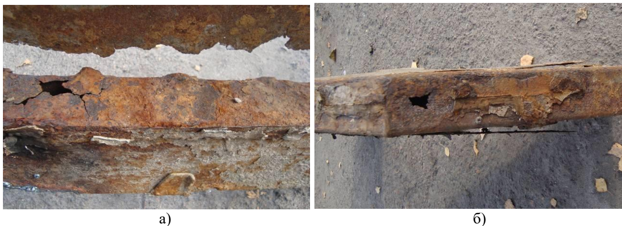
Рисунок 4 – Наскрізна корозія лонжеронів каркасу основи автобуса «Богдан А-092» (термін експлуатації 9 років) в районі задніх арок: а) верхня частина лонжерона профілем 140x60x3 мм; б) нижня частина лонжерона профілем 140x60x3 мм
