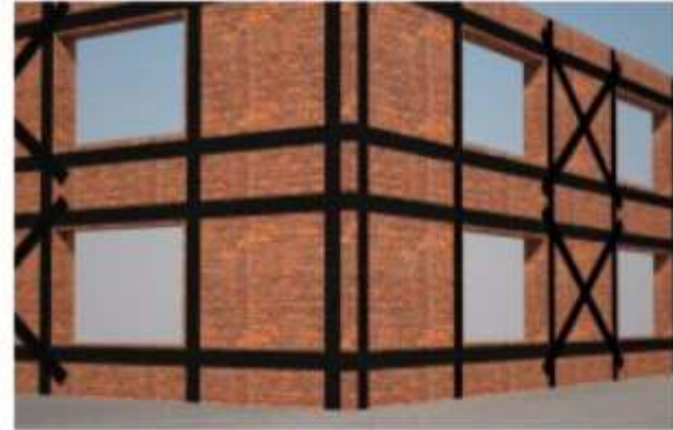
Підсилення деформованої цегляної стіни обіймою із арматури
