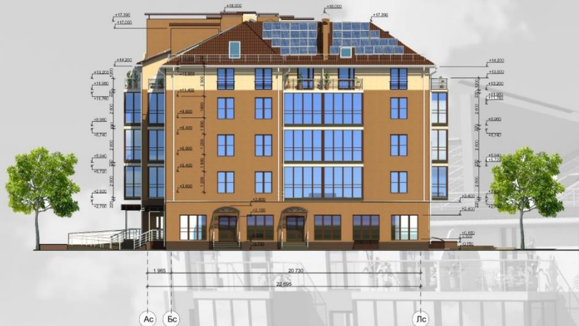
Фасад в осях Ас-Лс М 1:100
