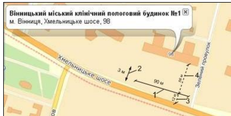
Рис. 5. Схема розташування шумозахисного екрану-стілки: 1 – шумозахисний екран-стілка, довжиною L=90 м; 2 – висота екрану-стілки h=3 м; 3 – відстань від смуги руху проїзної частини (джерела транспортного шуму) до екрану-стілки, l_1=12 м; 4 – відстань від екрану-стілки до будівлі пологового відділення, l_2=56 м.
