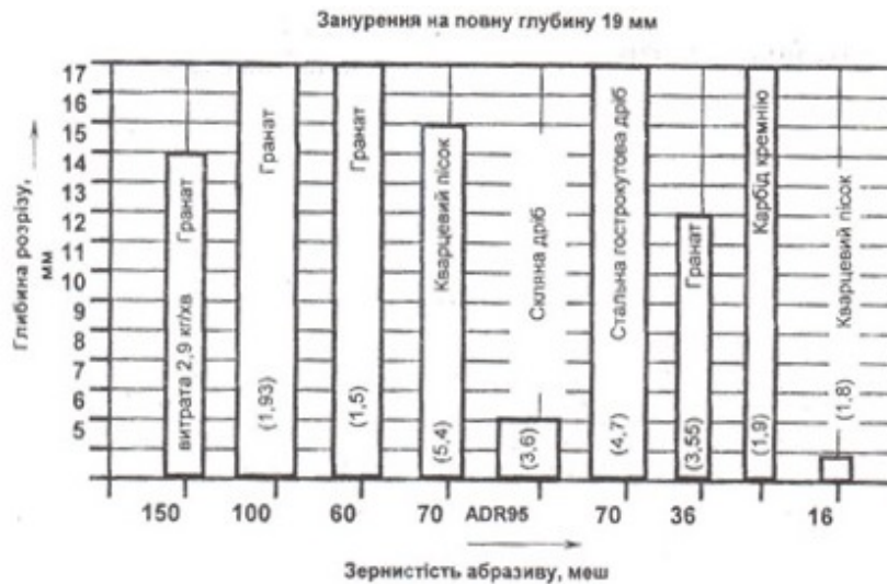
Рисунок 1 – Залежність глибини розрізу маловуглецевої сталі від матеріалу абразива та розмірів часток
