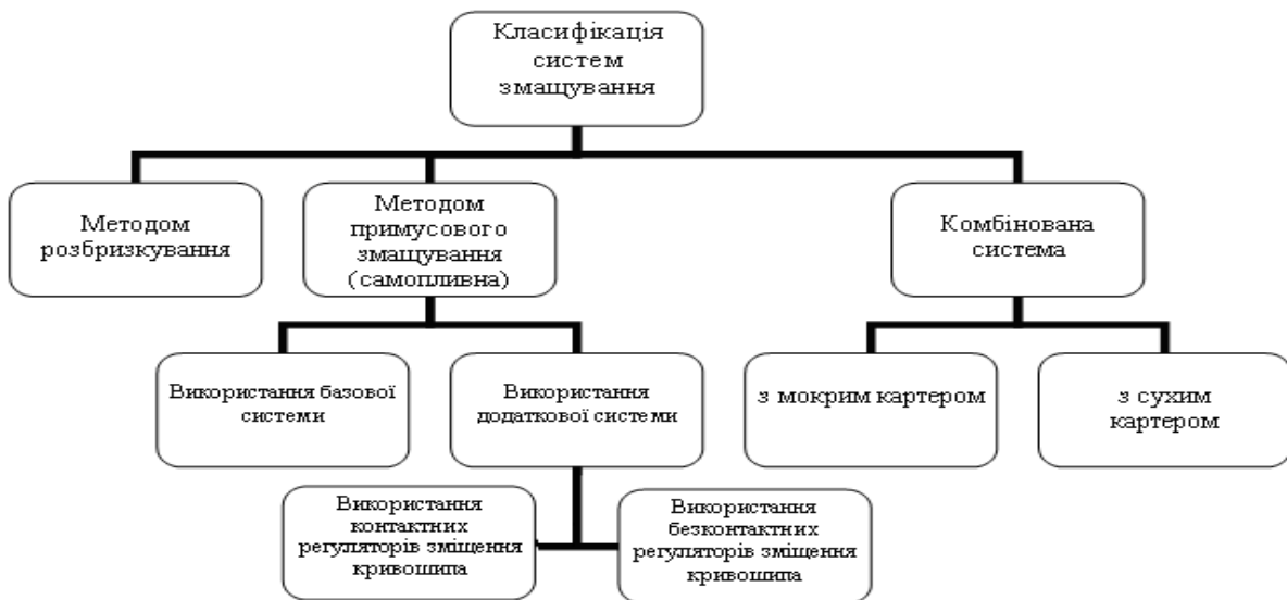
Рисунок 1 – Варіативні системи змащування спряжених робочих поверхонь ДВЗ
