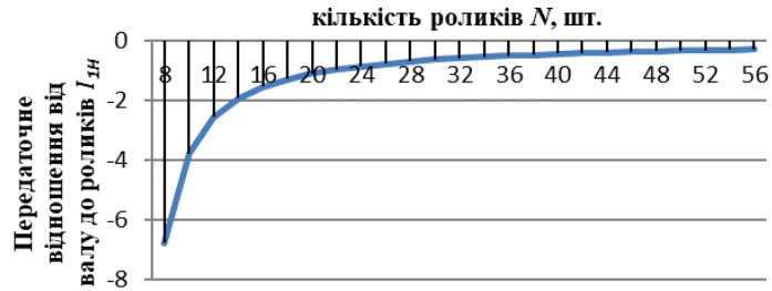
Рисунок 3 – Залежність передаточного відношення при передачі руху від валу до роликів від кількості роликів
