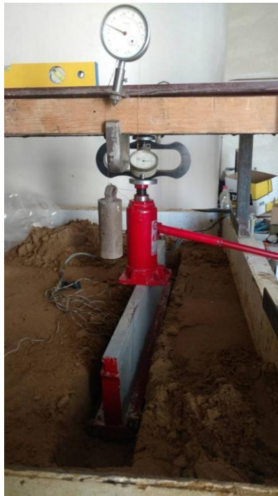
Рисунок 1 – Модель фундаменту в процесі випробування
