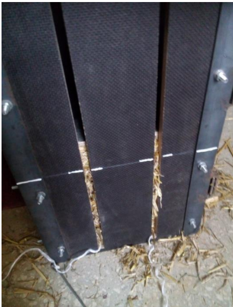
Рис. 1 Установка для пресування солом'яних тюків (зліва – відмітка потрібної висоти тюка на корпусі установки, справа – процес пресування з передачею зусилля через домкрат та упорну балку)
