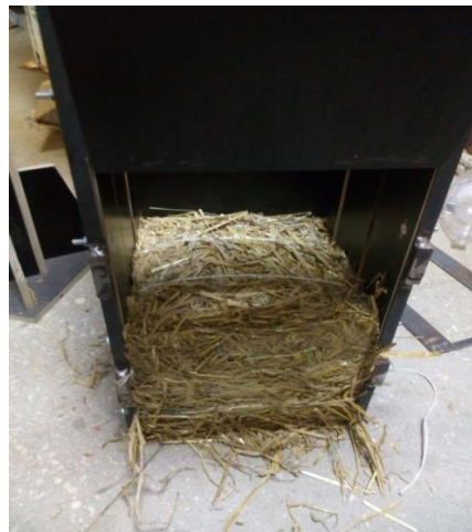
Рис. 1 Установка для пресування солом'яних тюків (зліва – відмітка потрібної висоти тюка на корпусі установки, справа – процес пресування з передачею зусилля через домкрат та упорну балку)
