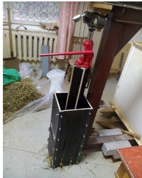
Рис. 1 Установка для пресування солом'яних тюків (зліва – відмітка потрібної висоти тюка на корпусі установки, справа – процес пресування з передачею зусилля через домкрат та упорну балку)
