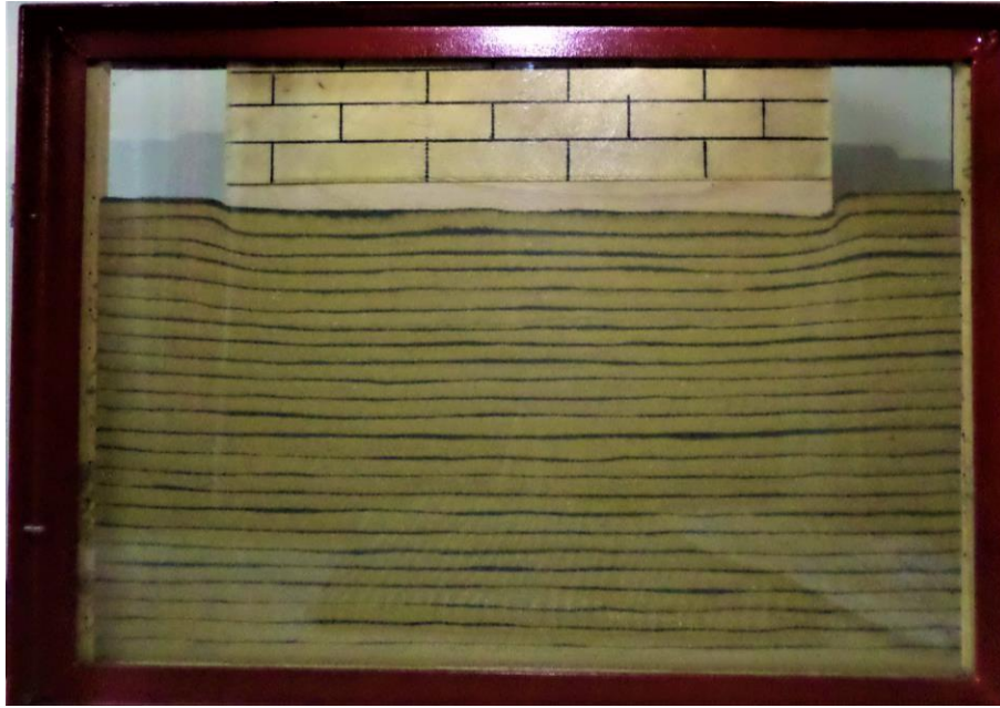
Рисунок 5 – Модель суцільного стрічкового фундаменту
