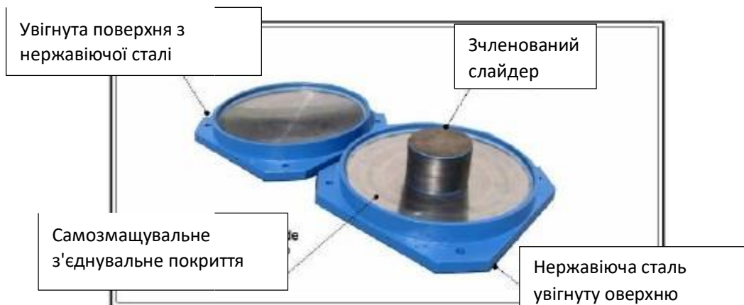
Рис. 14. Фрикційний ізоляційний слайдер
