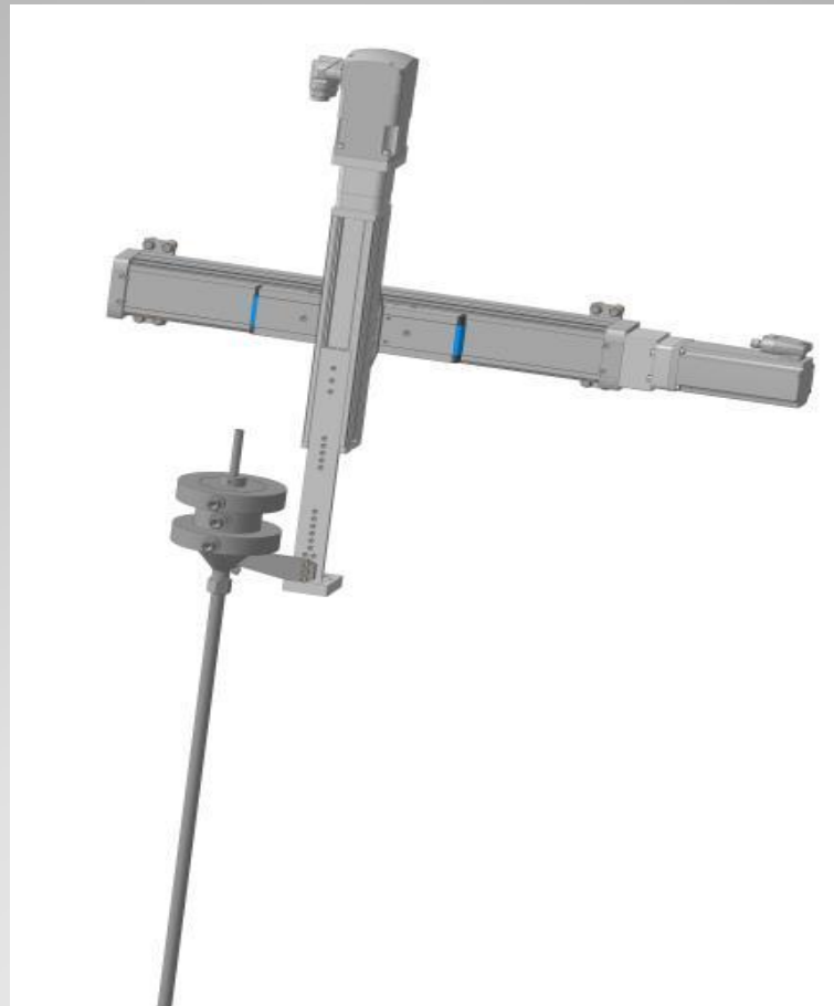
Механізм переміщення детонаційного розпилювача (3D модель)
