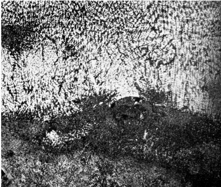
Мікροструктура перехідної зони наплавлений шар- основа, x100
