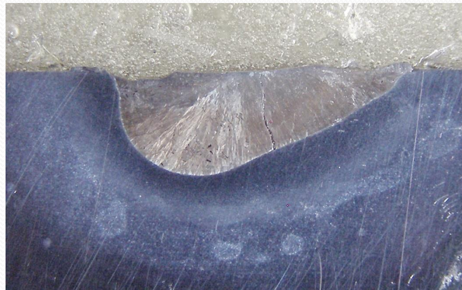
Макрошліф науглецьованого зразка. ВВМ в два шари
