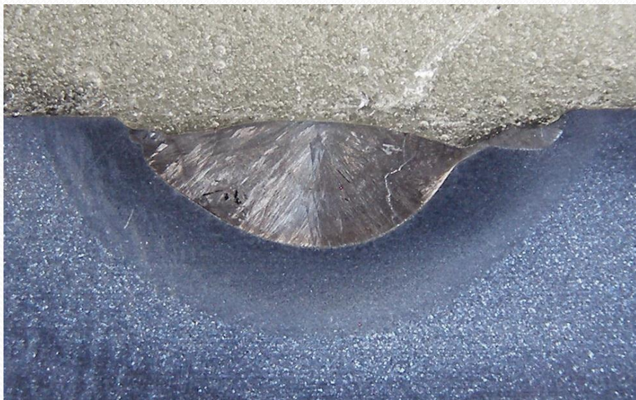
Макрошліф науглецьованого зразка. ВВМ в один шар
