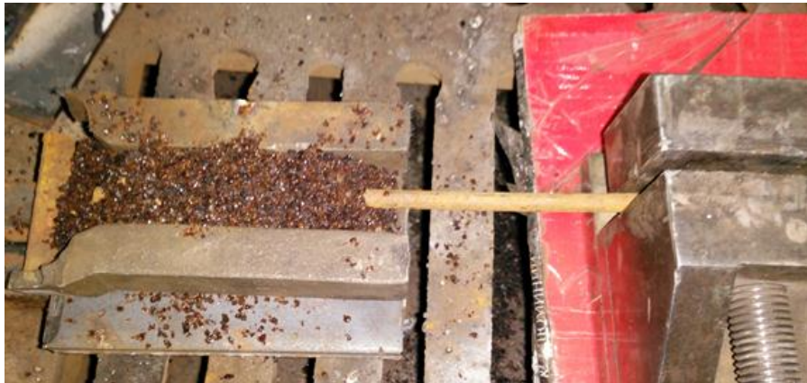
Рис. 2– Процес (зварювання) наплавлення лежачим електродом під шаром флюсу
