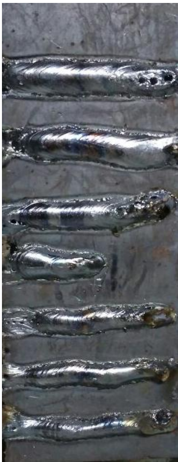
Рис. 1 – Наплавлені валики при різних значеннях сили зварювального струму.
