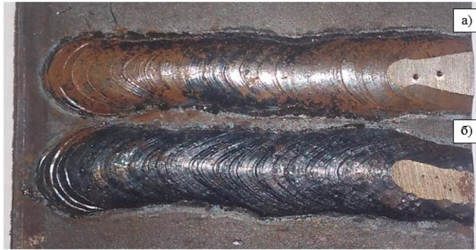
Рисунок 1 – Вимірювання твердості наплавлених швів: а – наплавлення лежачим електродом під шаром флюсу; б - наплавлення лежачим електродом під шаром суміші флюсу і вуглецю.
