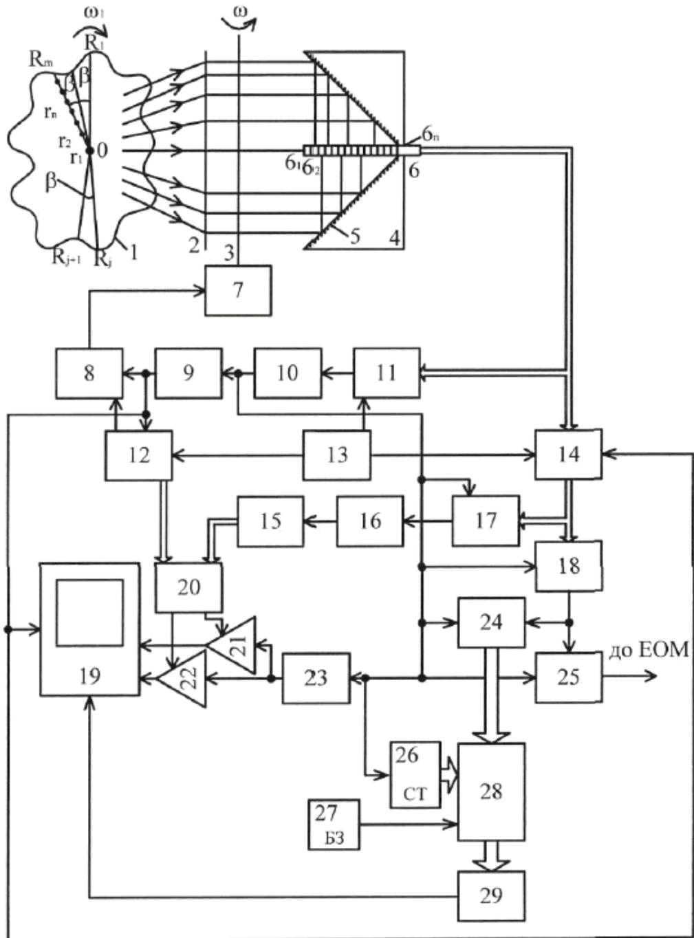
Корисна модель належить до безконтактної термометрії і може бути використана для вимірювання температури нерухомих об'єктів або об'єктів, що обертаються, зокрема потужних електричних машин.
