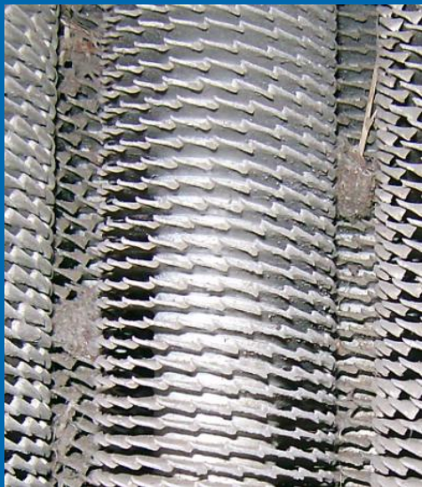
Забруднення системи охолодження трансформаторним маслом
