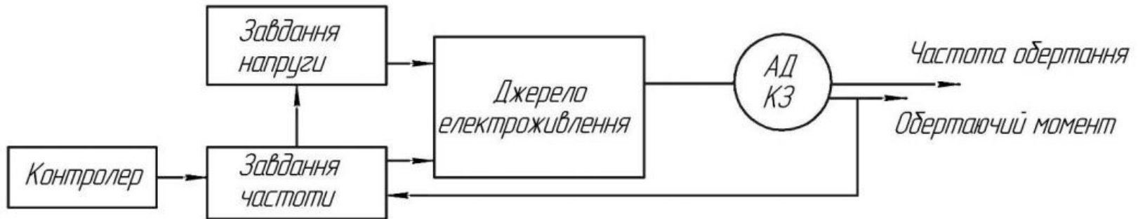
Рисунок 8 – Функціональна схема асинхронного приводу шахтного електровозу
