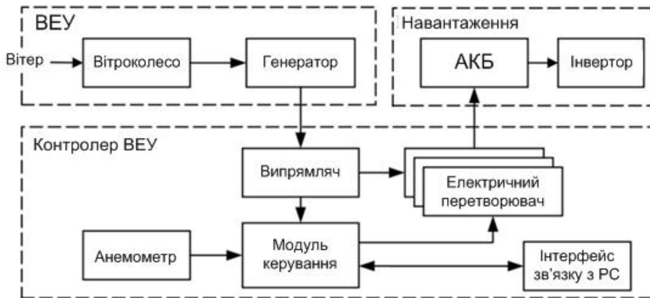
Рисунок 4 – Структурна схема контролера ВЕУ
