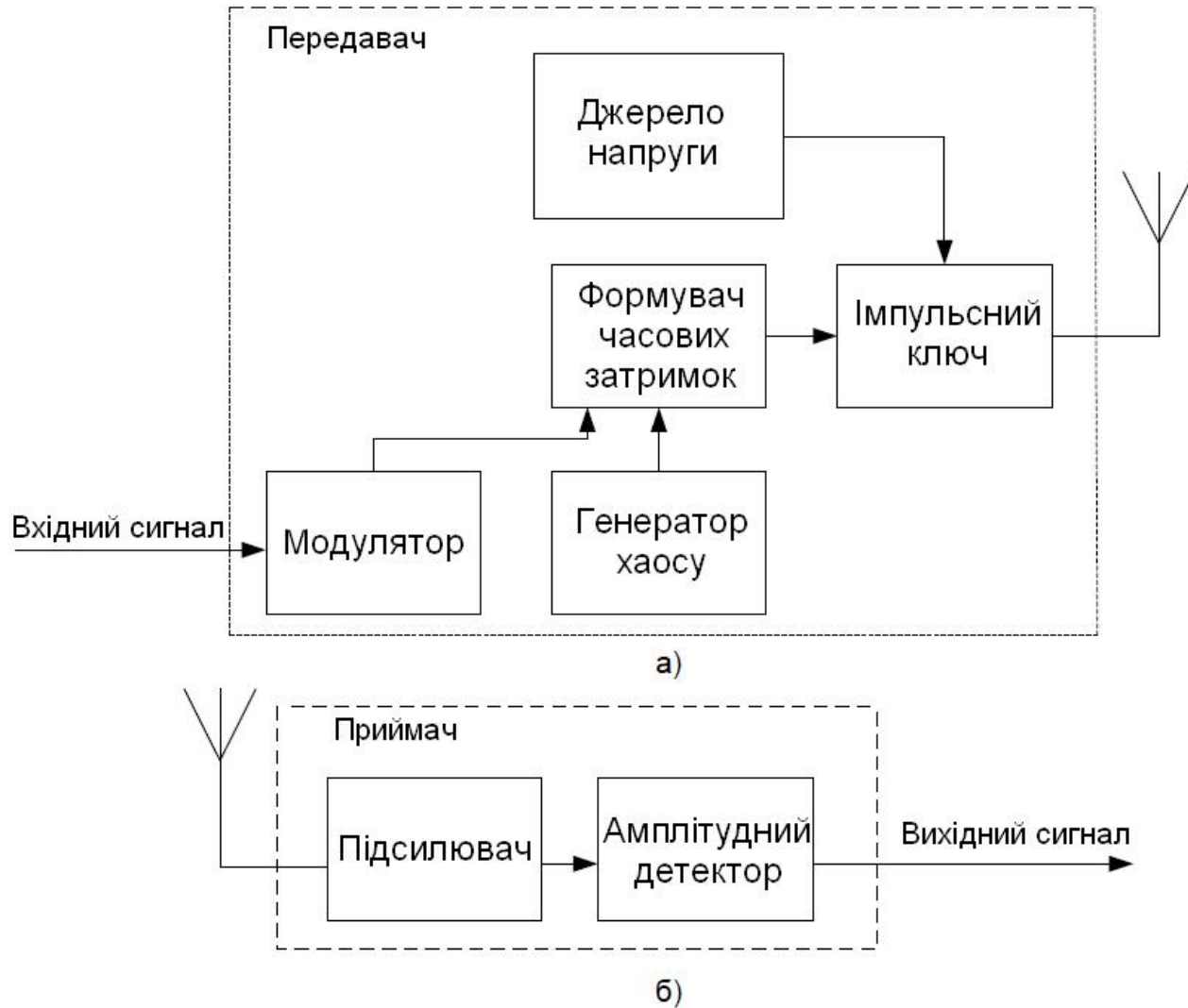
Рисунок И.1 - Структура системи зв'язку на основі генератора хаосу: а) приймальня частина, б) передавальна частина
