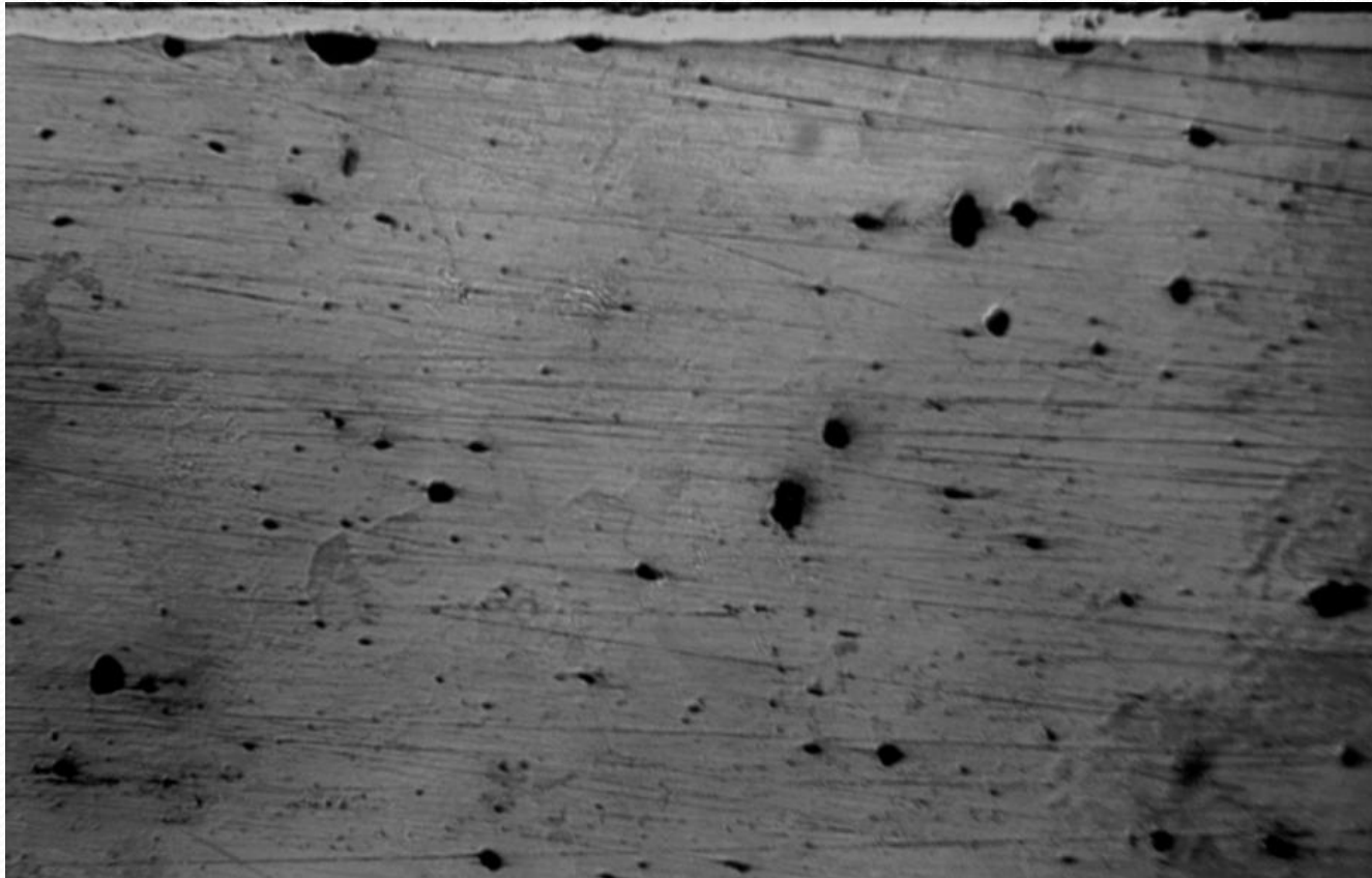
Мікрошліф зразка після дифузійної металізації (x100)
