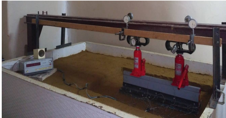
Рис. 1 – Випробування моделі стрічкового пального фундаменту
