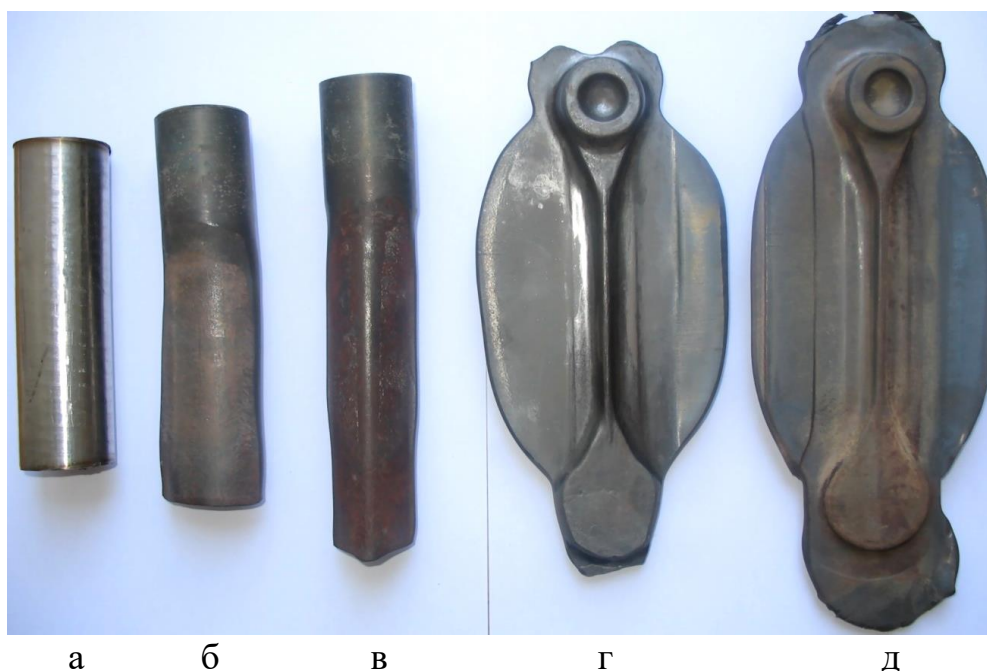
Рисунок 7 – Етапи виготовлення штампованої поковки «Качалка»: а) мірна заготовка; б) заготовка, що вальцюється, першого переходу «круг-овал»; в) вальцювальна заготовка другого переходу «овал-квадрат»; г) заготовка після підготовчого ривчака; д) штампована деталь
