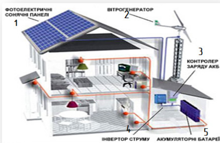
Рисунок 1 – Використання сонячної батареї у приватному будинку: 1 – фотоелектричні сонячні панелі; 2 – вітрогенератор; 3 – контролер заряду АКБ; 4 – інвертор струму; 5 – акумуляторні батареї
