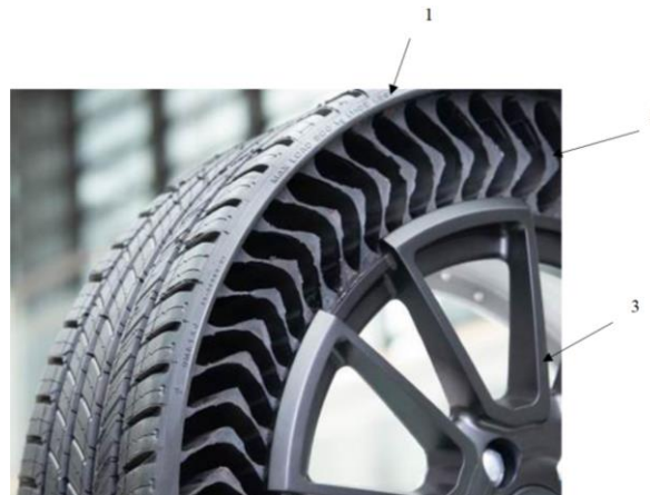
Рис. 3 – Фрагмент безповітряної шини: 1- протектор; 2- пружний елемент; 3- диск.
