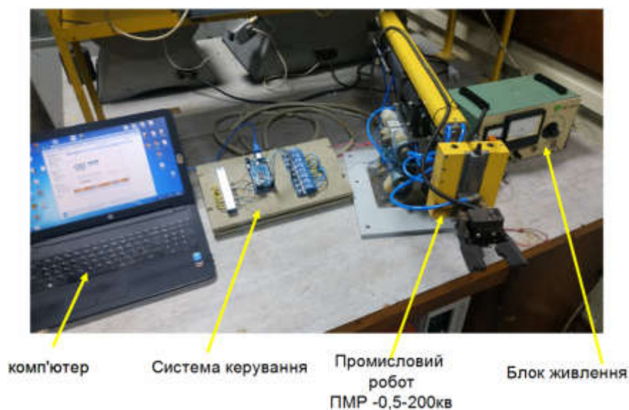
Рис. 1. Навчальний стенд на базі промислового робота ПМР-0,5-200кв
