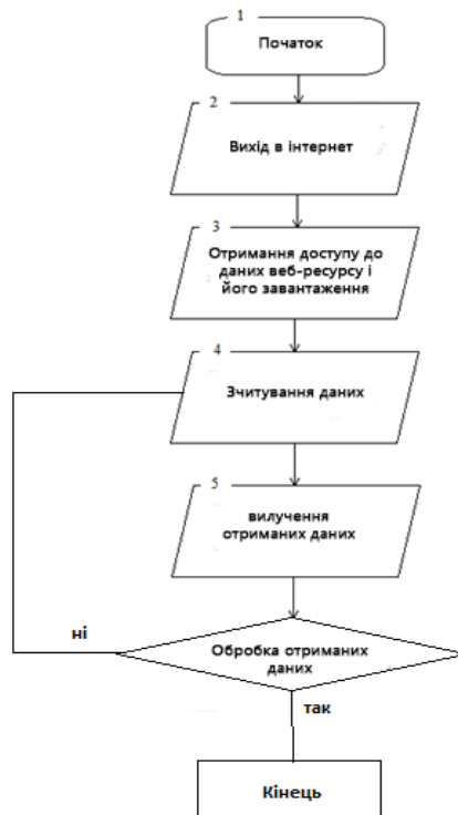
Рисунок 1 – Алгоритм роботи програмного забезпечення для моніторингу
