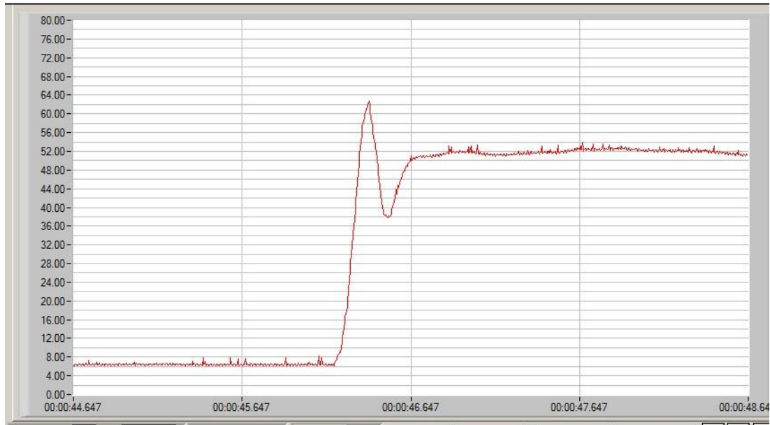
Рис. 6. Залежність величини тиску p_n на виході насоса від часу під час запуску
