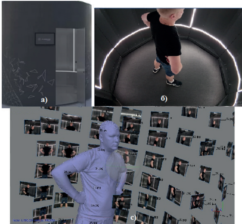
Рис. 4. Панорамні сканери TOB GENERATION: а) зовнішній вигляд сканера; б) внутрішній вигляд сканера; в) набір точок у спеціалізованому пакеті програм для фотограмметрії
