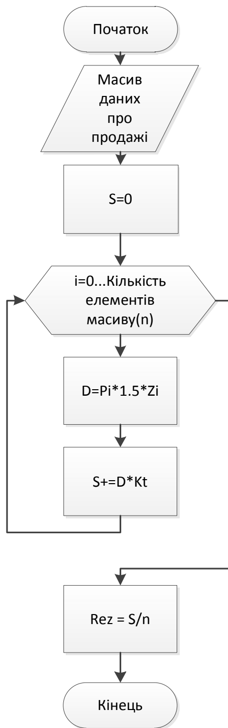
Рисунок 1 – Блок-схема алгоритму роботи програмного модуля прогнозування продажів на базі запропонованого комбінованого методу
