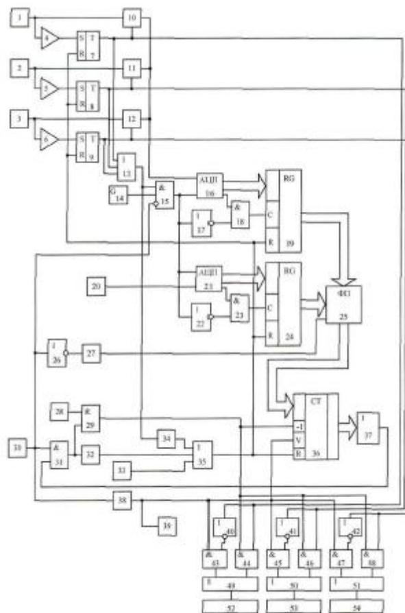
Корисна модель належить до галузі електротехніки і може бути використана для вимірювання комутаційного ресурсу повітряних високовольтних вимикачів.
