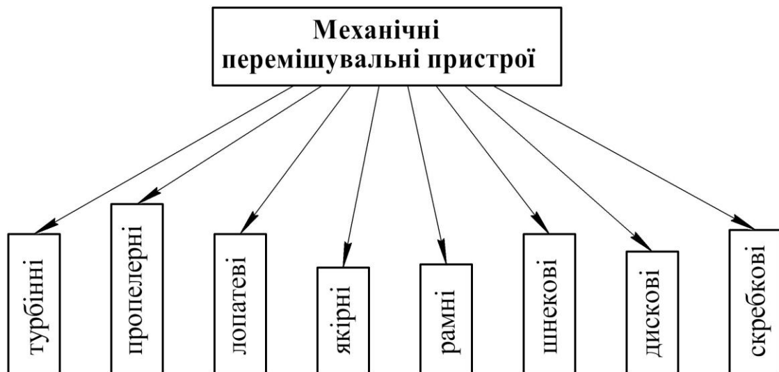
Рисунок 1.5 – Класифікація механічних перемішувальних пристроїв для біореакторів
