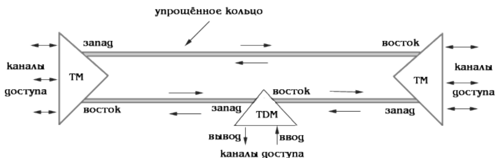
Рис. 2. Топологія тестової мережі типу кільце
