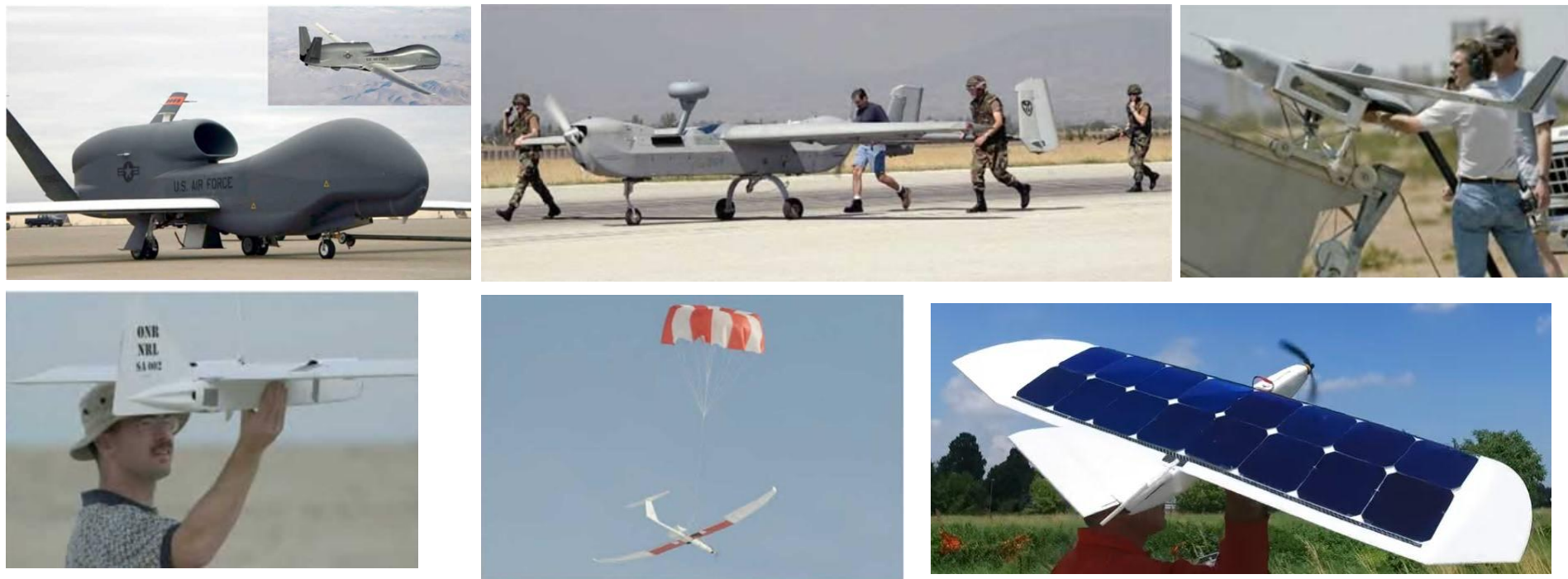
Рис. 2. БПЛА літакового типу: розвідувальний БПЛА RQ-4 Global Hawk (а), запуск БПЛА зі злітно-посадкової смуги (б), запуск БПЛА за допомогою стартової катапульти (в), ручний запуск БПЛА (г), посадка БПЛА за допомогою парашута (д), модель БПЛА на сонячних елементах без акумуляторних батарей (е)
