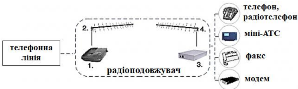
Рис. 3. Установка найпростішого ретранслятора в третій точці, що має пряму видимість з кінцевими точками
