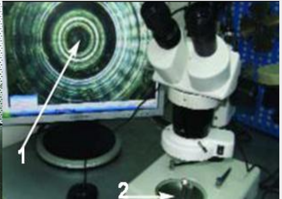
Пневматичний тестер для контролю стану сідла клапана мультиплікатора 1 – конусне сідло при необхідному збільшенні; 2 – клапан мультиплікатор
