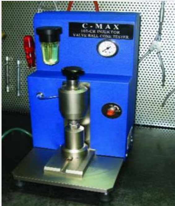
Пневматичний тестер для контролю стану сідла клапана мультиплікатора 1 – конусне сідло при необхідному збільшенні; 2 – клапан мультиплікатор
