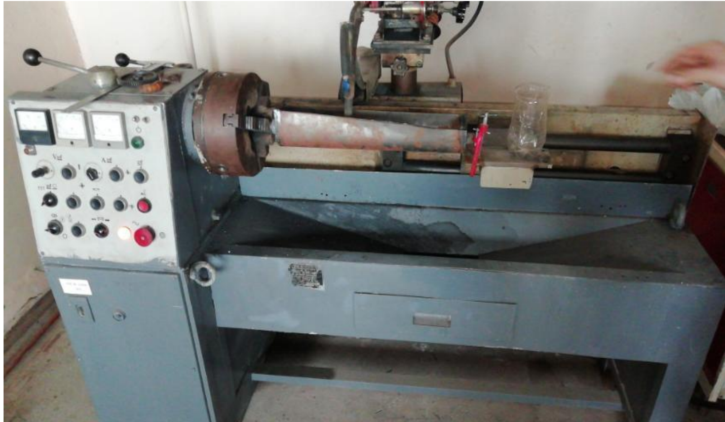
Рисунок 3 – Установка для наплавлення з водяним охолодженням
