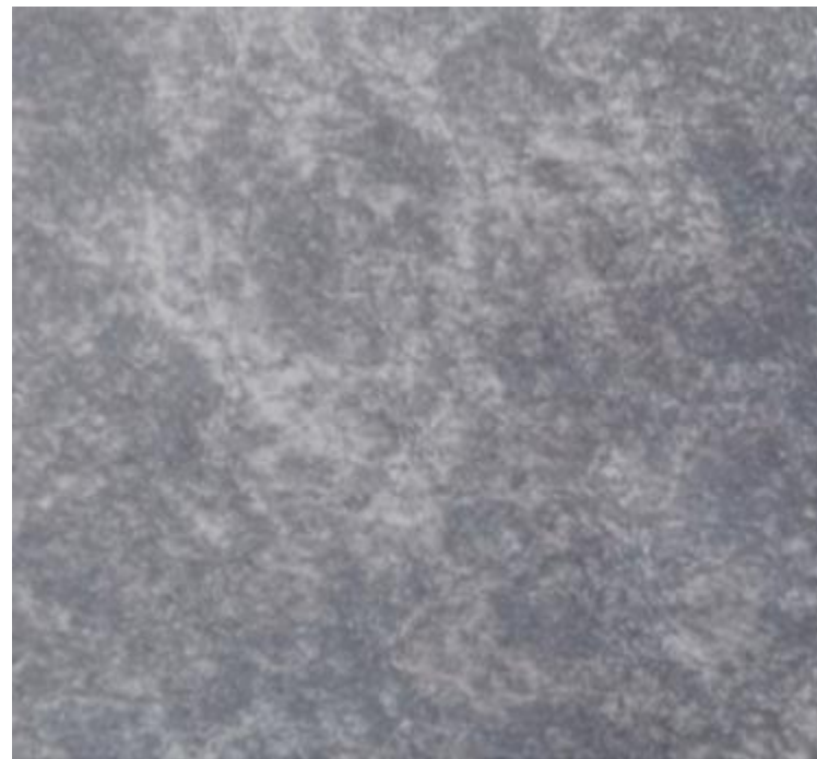
Рисунок 5 – мікро-структура покриття без охолодження
